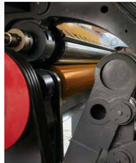
Particolare versione RR con cilindro pressatore cromato lucido Specific RR version con cilindro pressatore cromato lucido
