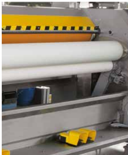
Particolare versione R con cilindro pressatore in ebanite Specific R version con cilindro pressatore in ebanite
