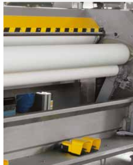
Particolare versione RA con cilindro pressatore a feltro Specific RA version con cilindro pressatore a feltro
