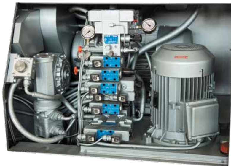
Particolare centralina idraulica Framming of hydraulic unit
