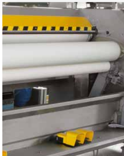
Particolare versione RA con cilindro pressatore a feltro Detalle versión RA con cilindro de presión de fieltro
