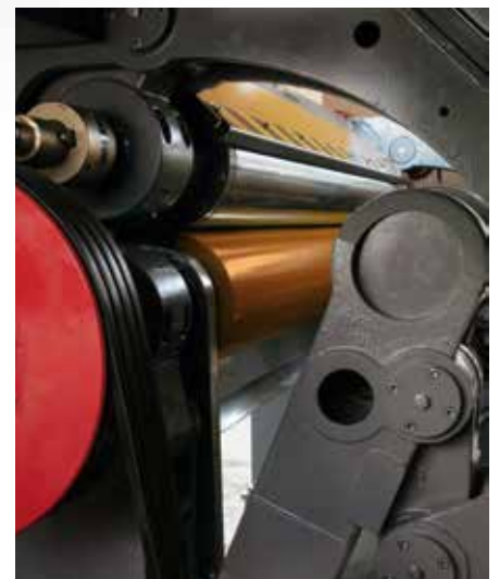
Particolare versione RR con cilindro pressatore cromato lucido Detalle versión RR con cilindro de presión cromado abrigantado
