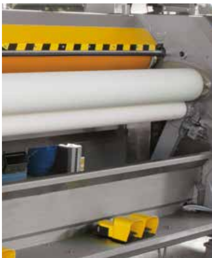
Particolare versione R con cilindro pressatore in ebanite Detalle versión R con cilindro de presión en ebonita
